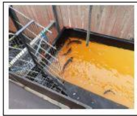
Vallitun pyyntilaitteen testausta , uusi nielu vasemmalla
